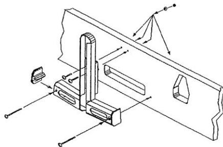
Fissare l'alzabiglia posizionando i 2 tappi in plastica alle estremità laterali dello stesso e avvitare utilizzando con le apposite viti e dadi
