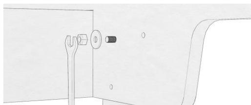
Fissare dalla parte interna del mobile la vite utilizzando la rondella 10x30 e il dado autobloccante e chiudere con la chiave da 17, permettendo comunque alla gamba di ruotare
