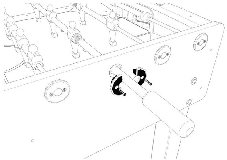
Fissare l'asta dal lato manopola con le due boccole, una dal lato interno l'altra da quello esterno del mobile, fissando il tutto con le due viti
