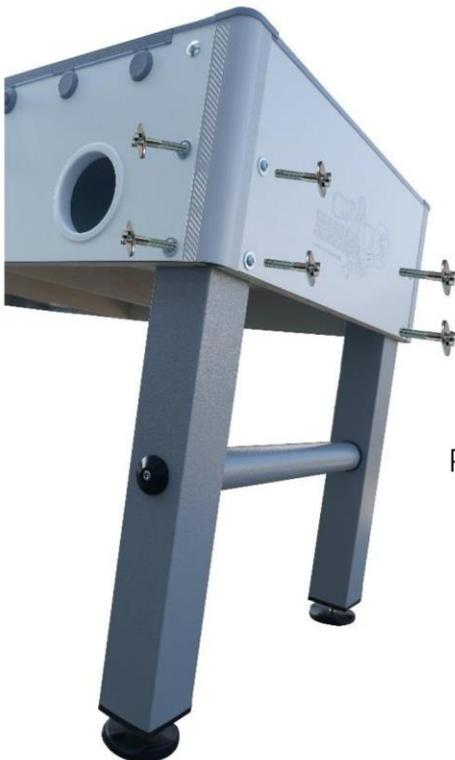
Dopo aver posizionato la rondella 8x24 nella vite 8x45, inserirli negli appositi fori delle gambe, senza stringere troppo per permettere il fissaggio della traversa.
